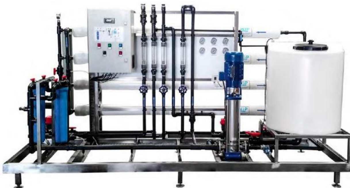
Figure 37 : exemple d'osmoseur industriel monté sur skid pour le traitement de volume allant de 0,9 à 14,4 m³/h (source: josome.fr)
